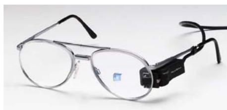
Abbildung 4: Datenbrille von MicroOptical
